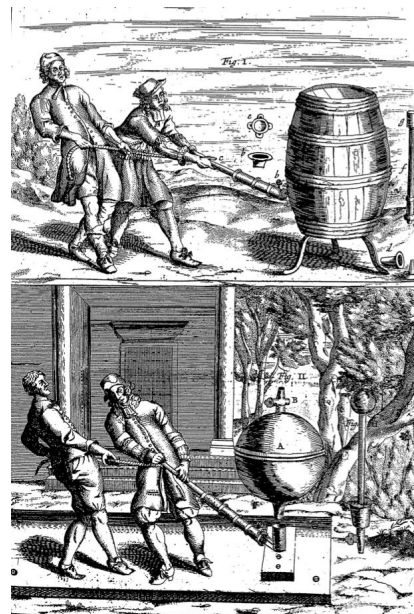
Rys.1. Doświadczenia z drewnianą beczką oraz metalowymi półkulami (Guericke 1672,74).
